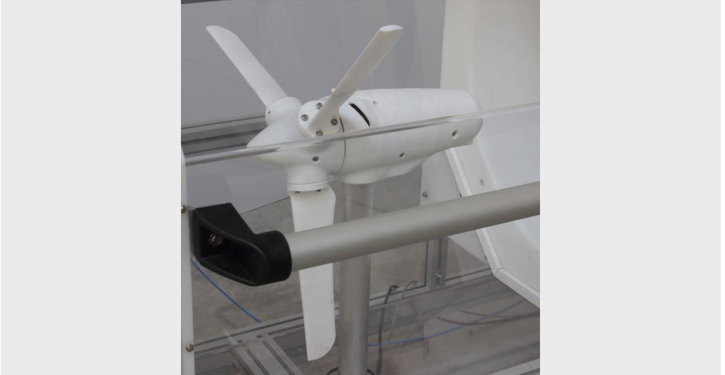
La turbina está completamente desarrollada y fabricada por DIKOIN, y dispone de sistemas electrónicos de medida de velocidad de giro así como de par. Además dispone de un sistema electrónico de regulación del pitch.
